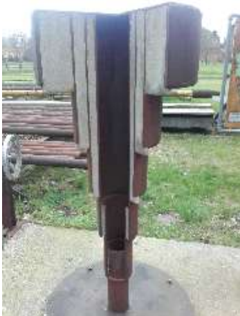
Figuur 4: een beeld van de in het boorgat aangebrachte buizen met het cement aan de buitenzijde
